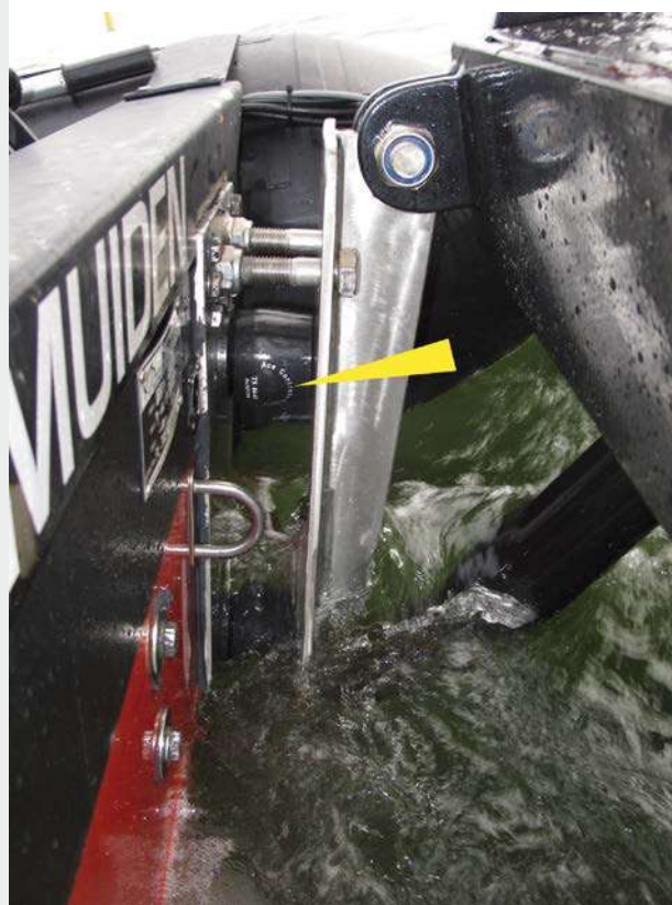
I robusti profili di ammortizzamento TUBUS, resistenti all'acqua di mare e realizzati in elastomero di copoliestere, consentono agli equipaggi delle navi di attraccare in tutta sicurezza Wals Diving and marine service, 1970AC Ijmuiden, Paesi Bassi
