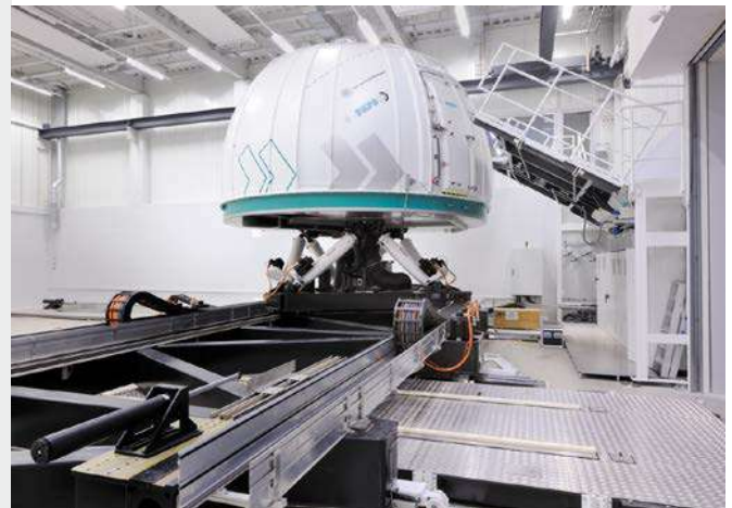
I deceleratori di sicurezza ACE salvaguardano le posizioni finali su due assi di un simulatore di guida Bosch Rexroth B. V., 5281 RV Boxel, Paesi Bassi e Università di Stoccarda - FKFS, 70569 Stuttgart, Germania
