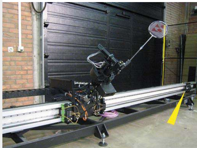
Svariati tipi di deceleratori sono utilizzati per rallentare i movimenti rapidi di un robot "badminton". FMTC vzw, 3001 Leuven, Belgio
