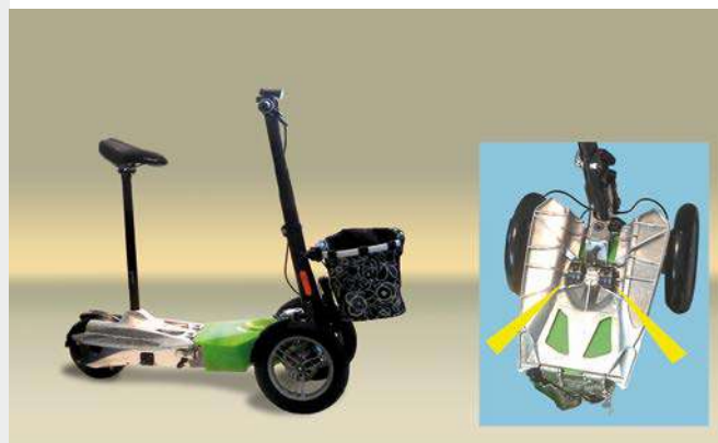
I profili di ammortizzamento aumentano il comfort di guida di uno scooter elettrico
