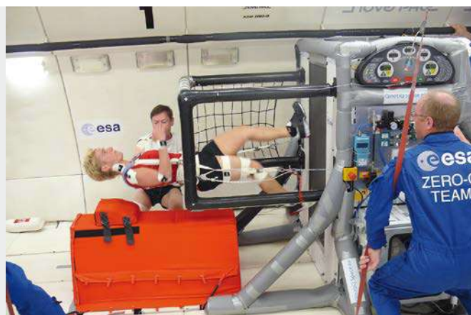
I profili di ammortizzamento TUBUS sono utilizzati per proteggere una macchina di fitness in assenza di gravità QinetiQ Space nv, 9150 Kruibeke, Belgio
